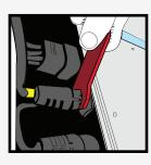
PULL CONNECTOR TO DISCONNECT FOOTPAD FROM CONTROLLER
